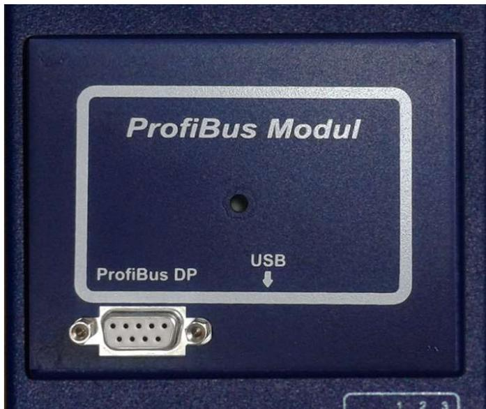
Die Einstellung der Profibusadresse erfolgt mittels RS232 Verbindungskabel und SFU Terminal Programm.
