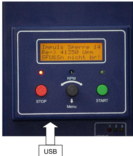
Als Option ist auch eine zusätzliche RS232 auf einer DSUB 9 verfügbar (Pinning wie > 6.11). Diese ist mit dem USB verknüpft und kann nur alternativ verwendet werden.
